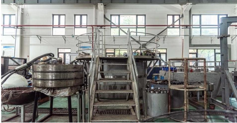
图 2 深海压力试验装置
