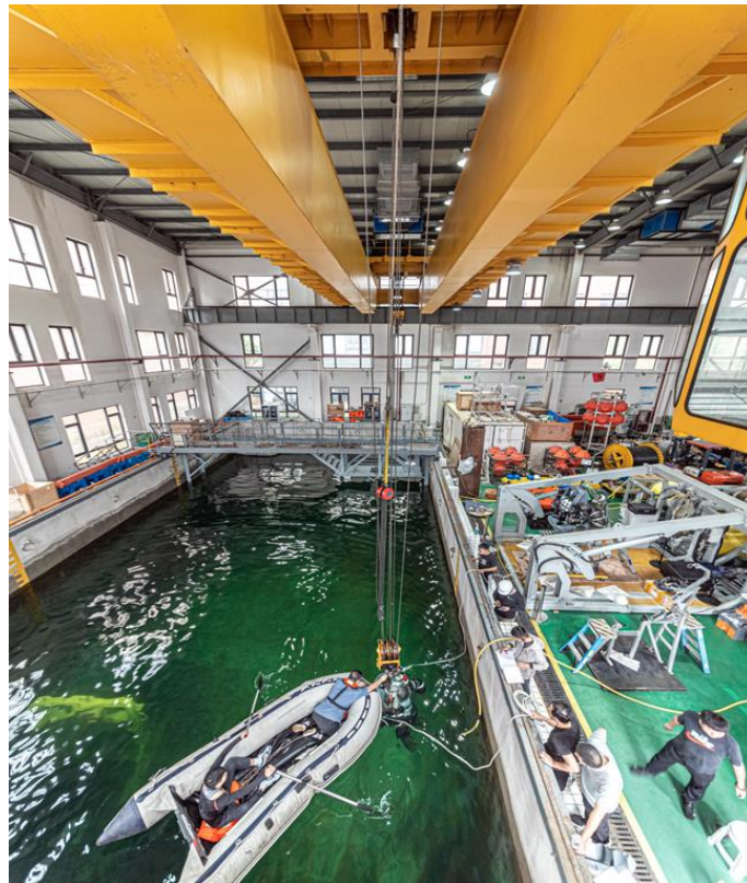
图 1 深海潜水器总装调试水池
